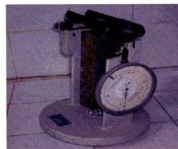
**Figure n° 5 : Rétractomètre-mesure des variations dimensionnelles**
