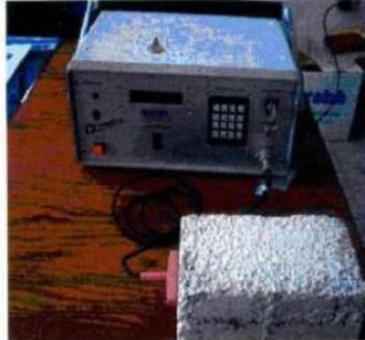
Figure 2 : CT mètre - mesure de la conductivité thermique
